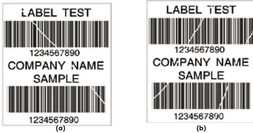
調整圈數每次以半圈為一個單位調整，調整後請再作列印測試，如碳帶皺褶未改善，請依上述方式再作調整，而調整圈數不得超過 2 圈(即調整次數為 4 次)。
