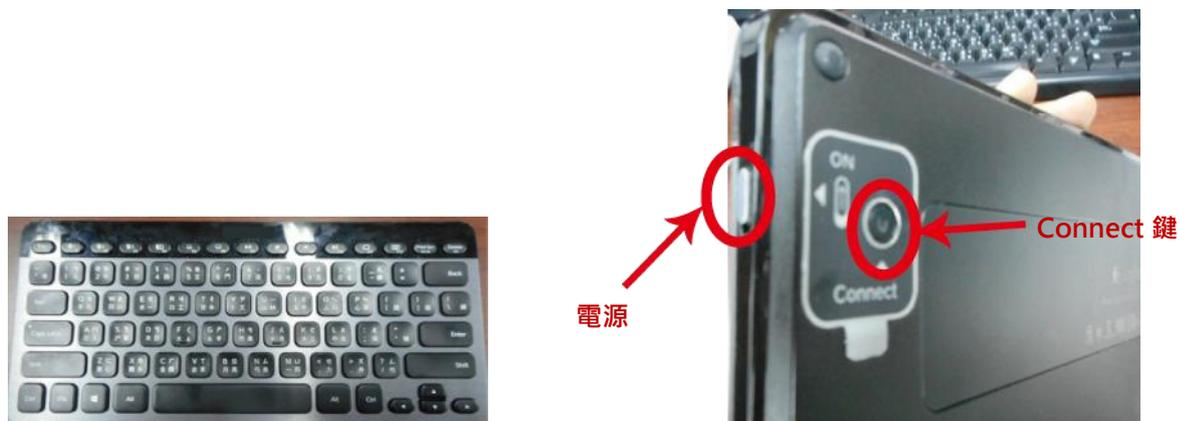
步驟 1. 開啟藍牙鍵盤的電源後，按下“Connect”鍵，使印表機可搜尋到藍牙鍵盤
